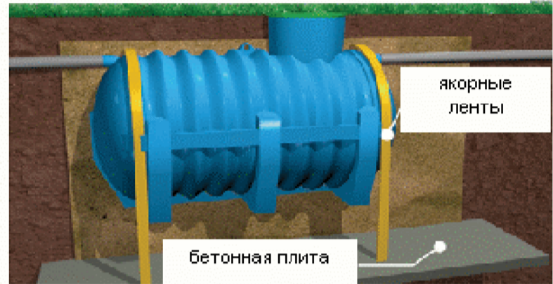
Установка резервуара в обводненных грунтах
